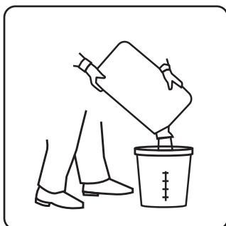
1 Высыпьте содержимое мешка в емкость с чистой водой из расчета 1 кг сухой смеси на 0,22-0,24 л воды (на 1 мешок 25 кг — 5,5-6 л., на мешок 40 кг — 8,8-9,6 л воды).
