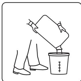
**1** Высыпьте содержимое мешка в емкость с чистой водой из расчета 1 кг сухой смеси на 0,42 - 0,48 л воды (на 1 мешок 20 кг – 8,4 – 9,6 л воды).
